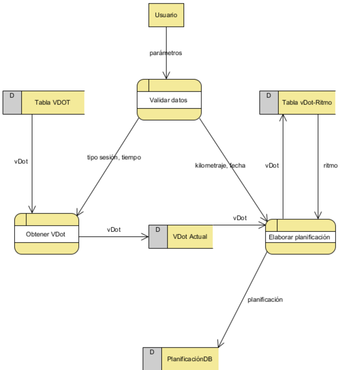
Figura 11.8. Diagrama de flujos de datos para el proceso Crear planificación
