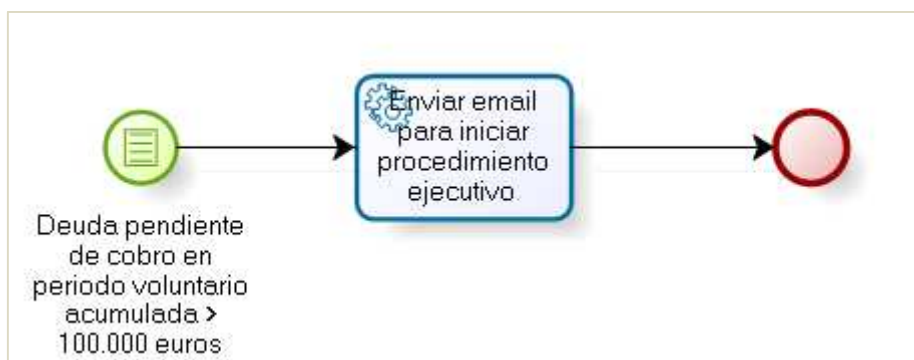
Ilustración 4.16. Ejemplo de uso de un proceso que se inicia al activarse un evento condicional
