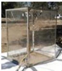
0,5m x 0,6m. La estructura está formada por 12 segmentos de aluminio con 5 láminas de poliéster transparente las cuales forman las paredes de la cámara. La parte inferior de la cámara queda fijada al suelo mediante la colocación de collares.
