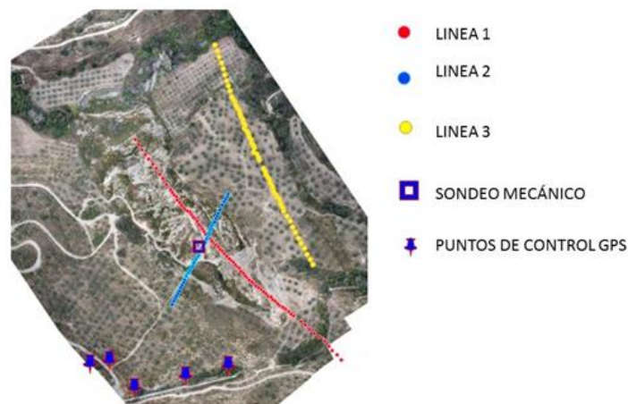
Figura 2. Situación de los perfiles eléctricos, sondeo y puntos de control GPS.
